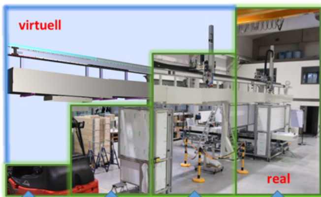
ABB.1: Gewünschter nahtloser Übergang von Inbetriebnahme virtuell zu real ABB.2 Reale und virtuelle IMS Lehranlage der Fa. Lucas-Nülle am ISW
