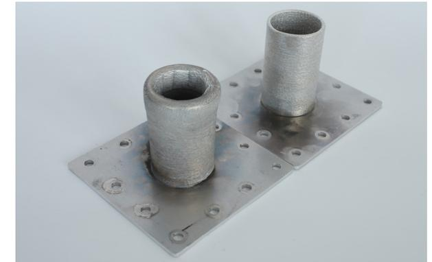
Laserauftragsschweißen mit Metalldraht: Konventionell (links) und mit lernender Vorsteuerung (rechts)
