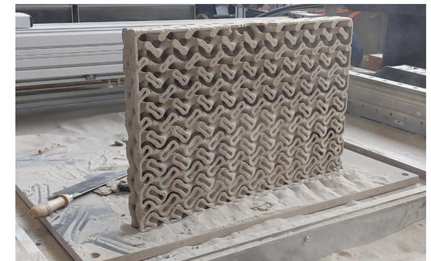
Additiv gefertigte Sandschalungen für leichte Betonbauteile
