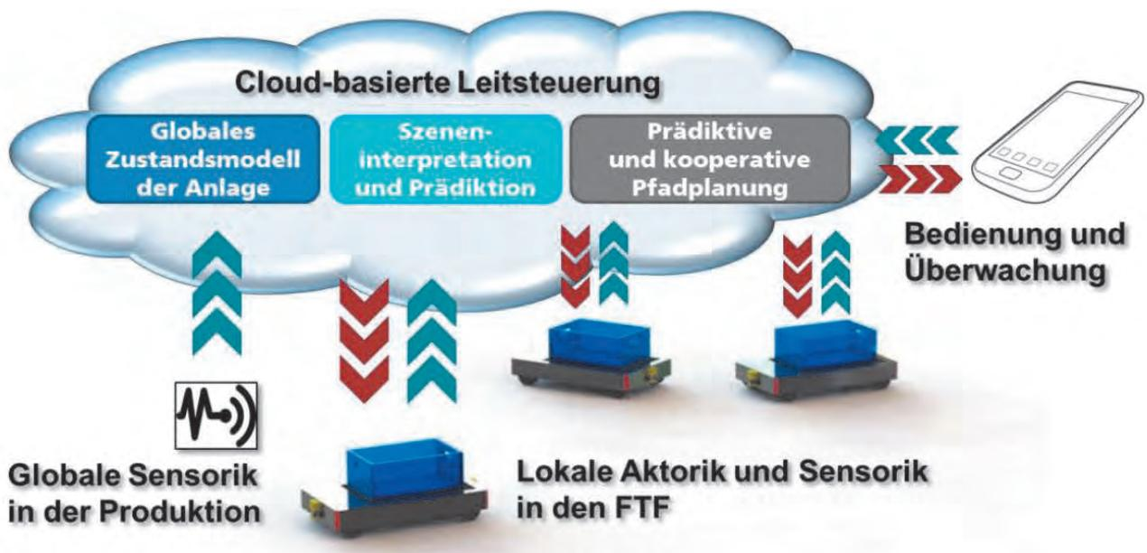
Bild 1: Übersicht der Systemkomponenten und Informationsflüsse in CLON-I4.0
