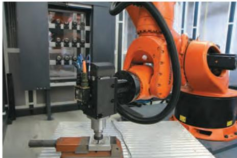
Bild 1: Acht-Achs-Bearbeitungsroboter am ISW
