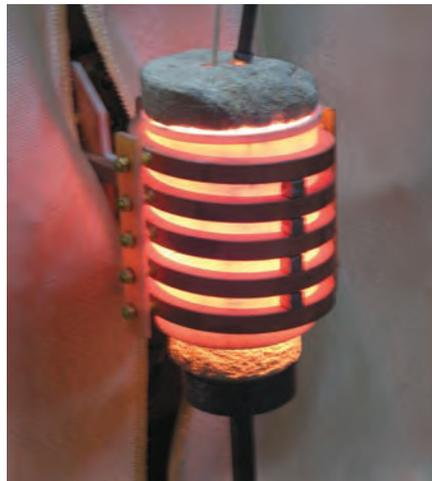
Bild 1: Induktives Erwärmen eines Titanbolzen (TiAl6V4)
