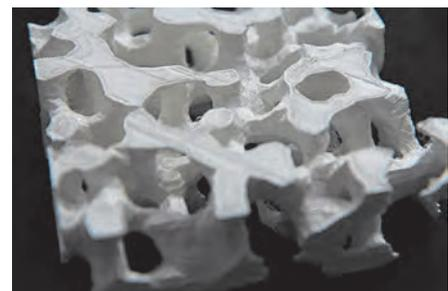
Additive Fertigung bionischer Bauteile
