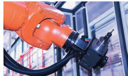
7-Achs KUKA KR500-Roboter-Bearbeitungszelle
