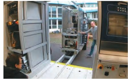
Bild 3: Einbau eines Prozessmoduls über ein Schienensystem
