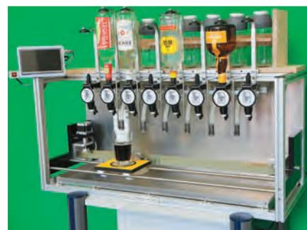
Bild 1: Automatisierter Cocktailmischer
