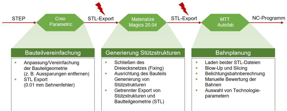
Abbildung 3: Betrachten des Datentransfers im aktuellen hybriden Fertigungsprozess ohne hybrides CAM-System am Beispiel der verwendeten Software in der Referenzkette.
