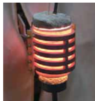
Bild 2: Induktives Erwärmen von Titan (TiAl6V4)
