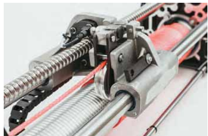
Bild 3: Mockup der aktuellen Version der IPAnema Seilantriebswinden mit integrierter Steuer- und Sensortechnik
