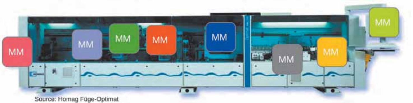
Bild 1: Maschine aus mechatronischen Modulen
