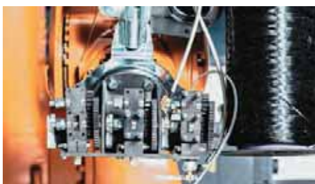
Bild 3: FDM-Druckkopf an einem Roboter mit CFK-Faser [Quelle: Fhg-IPA]
