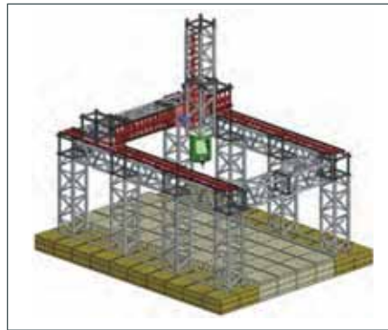
Bild 2: Vision einer Werkzeugmaschine aus modularen Leichtbaustrukturelementen
