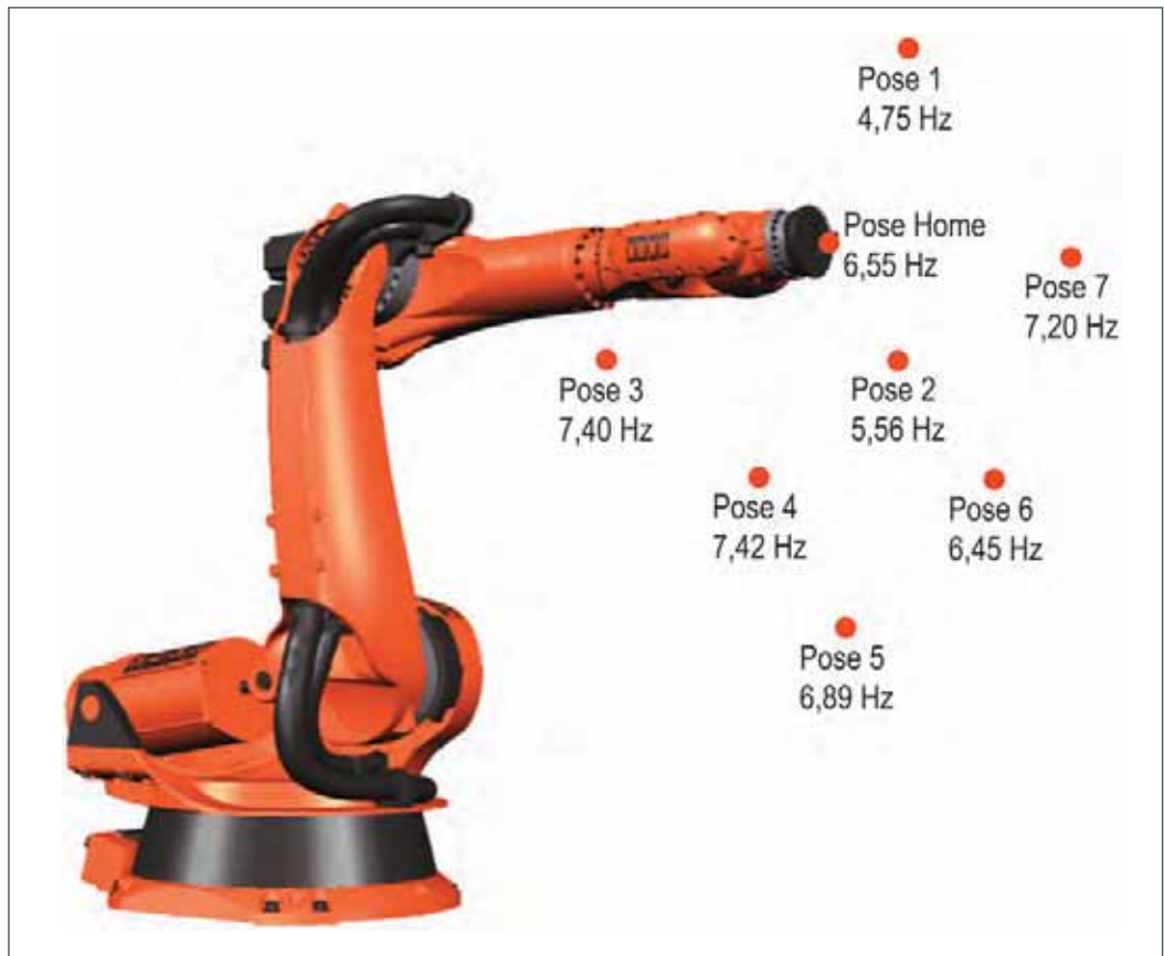
Bild 2: Posenabhängige Eigenfrequenzen beim Bearbeitungsroboter
