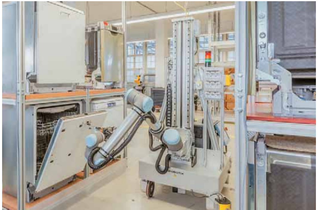
Bild 1: Automatisches Öffnen einer Spülmaschinentür durch mobilen Roboter (Quelle: Fraunhofer IPA)
