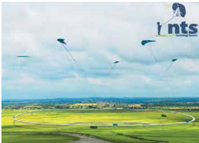
Bild 1: Konzept der Anlage (Quelle: NTS)
